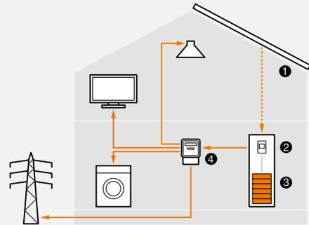
Bei voll aufgeladenen Batterien versorgt das System den Eigenverbrauch und speist überschüssige Energie ins Stromnetz ein.
