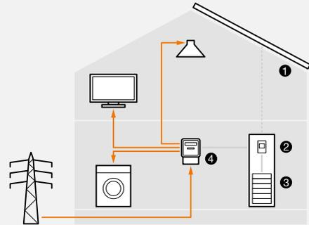
Sollte die Kapazität der Batterie nicht ausreichen, wird Strom aus dem öffentlichen Netz bezogen, um den Strombedarf zu decken.
