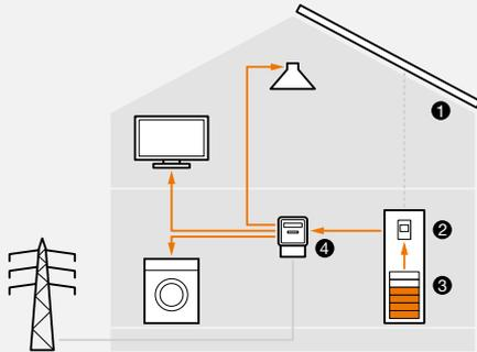
Nach Sonnenuntergang stellt das System Energie aus der Batterie zur Verfügung. Der VS 5 Hybrid hilft, Eigenverbrauchsquoten von 70% und mehr zu erreichen.
