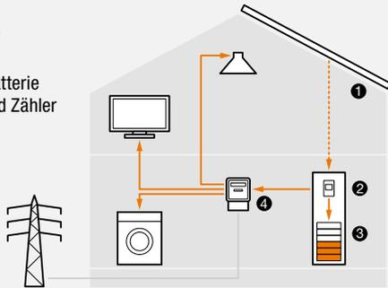
Die im PV-Generator (1) produzierte Energie wird vorrangig zur Optimierung des Eigenverbrauchs genutzt. Überschüssige Energie wird zum Aufladen der integrierten Lithium-Ionen Batterien (3) genutzt.
