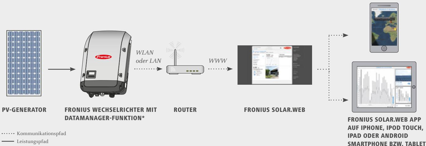
\* Bei den Wechselrichtern Fronius Galvo, Fronius Symo und Fronius Symo Hybrid ist der Fronius Datamanager standardmäßig integriert. Die nachträgliche Installation eines Fronius Datamanager bzw. Fronius Datamanager Box ist problemlos möglich. Voraussetzung zur Nutzung der Fronius Solar.web Apps ist ein Fronius Solar.web Konto.
