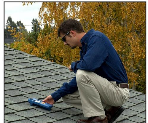
*Die Messung der Dachneigung ist jetzt im SunEye 210 integriert. Legen Sie einfach das Gerät auf das Dach oder Modul und lesen Sie Neigung und Azimut ab.*
